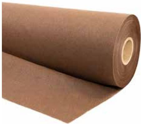
Speciale telo geotessile marrone non tessuto 100% polipropilene vergine ad alta tenacità, stabilizzato UV coesionato meccanicamente mediante agugliatura e calandrato, senza trattamenti chimici.
